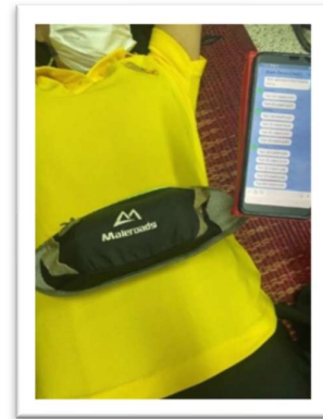
ภาพที่ 18 การทดลองเครื่องเตือนการล้มผ่านแอปพลิเคชันไลน์ เมื่อมีการล้มทางด้านหลัง
