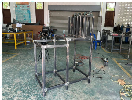
รูปที่ 2 ทำโครงสร้างแท่นเครื่อง ระบบตรวจจับเส้นด้าย และระบบควบคุมควบคุมเครื่องกรอเส้นไหม
