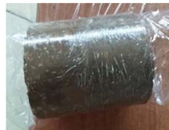
ภาพที่ 7 นำตัวอย่างดินที่บดอัดเรียบร้อยแล้วห่อด้วยพลาสติกกันความร้อน และบ่มที่อุณหภูมิห้องจนถึงวันที่ กำหนดทดสอบตัวอย่าง (7วัน)
