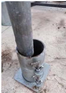
ภาพที่ 5 ตักดินที่ทำการผสมไว้แล้วใส่โมล โดยแบ่งดินเป็น 3 ส่วนเท่ากัน และทำการบดอัดโดยใช้ ค้อนขนาด 10 ปอนด์ กระทุ้งดินในโมล ชั้นละ 25 ครั้ง จำนวน 3 ชั้น โดยพยายามบดอัด ให้ได้ความหนาแน่นของดินแต่ละชั้นเท่ากันสม่ำเสมอ โดยในชั้นสุดท้ายให้เหลือดินส่วนบนของโมลเล็กน้อยประมาณ 1-2 เซนติเมตร
