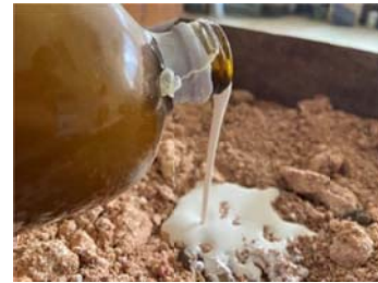
ภาพที่ 4 เทน้ำที่ทำการผสมน้ำยางพาราลงในดินที่ จากนั้นทำการคลุกเคล้าให้เข้ากัน
