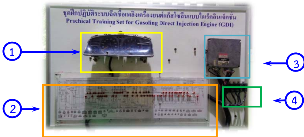
ภาพที่ 3 ส่วนประกอบแผงวงจรไฟฟ้าควบคุมระบบฉีดเชื้อเพลิงอิเล็กทรอนิกส์ ที่มา : นายยงยุทธ เครือวงษา (2561).
