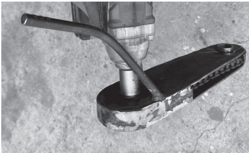
ภาพที่ 7 การทดลองระบบการทำงานของเครื่องมือถอดประกอบน็อตหม้อแปลงไฟฟ้า
