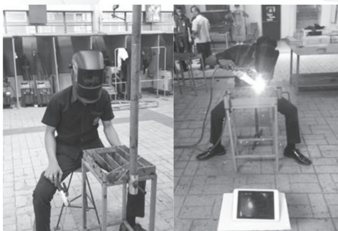
ภาพที่ 5 การทดสอบการใช้งานหน้ากากพัฒนาคุณภาพงานเชื่อมโลหะ
