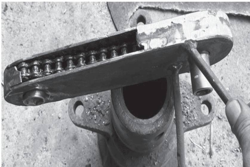
ภาพที่ 5 ประกอบชุดโซ่เข้ากับแผ่นเหล็ก
