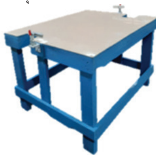
รูปที่ 10 โต๊ะสำหรับทำแผ่นประกบคู่ที่เสร็จสมบูรณ์
