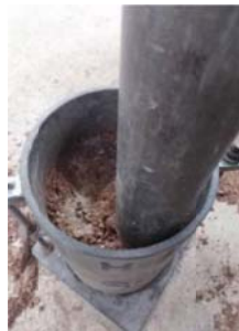
ภาพที่ 5 ตักดินที่ทำการผสมไว้แล้วใส่โมล โดยแบ่งดินเป็น 3 ส่วนเท่ากัน และทำการบดอัดโดยใช้ ค้อนขนาด 10 ปอนด์ กระทุ้งดินในโมล ชั้นละ 25 ครั้ง จำนวน 3 ชั้น โดยพยายามบดอัด ให้ได้ความหนาแน่นของดินแต่ละชั้นเท่ากันสม่ำเสมอ โดยในชั้นสุดท้ายให้เหลือดินส่วนบนของโมลเล็กน้อยประมาณ 1-2 เซนติเมตร
