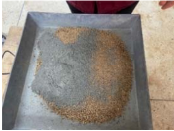
ภาพที่ 3 ผสมดินและผงซีเมนต์ที่เตรียมไว้เตรียมไว้ จากนั้นคลุกเคล้าให้เข้ากัน
