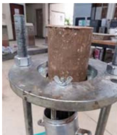
ภาพที่ 6 นำโมลออกจากตัวอย่างดินบดอัดด้วยเครื่องดันตัวอย่างดิน
