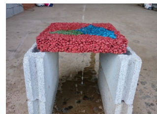
ภาพที่ 6 การทดสอบการเทน้ำลงบนบล็อกปูพื้น
