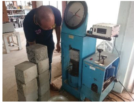
ภาพที่ 3 การทดสอบกำลังอัดคอนกรีต
