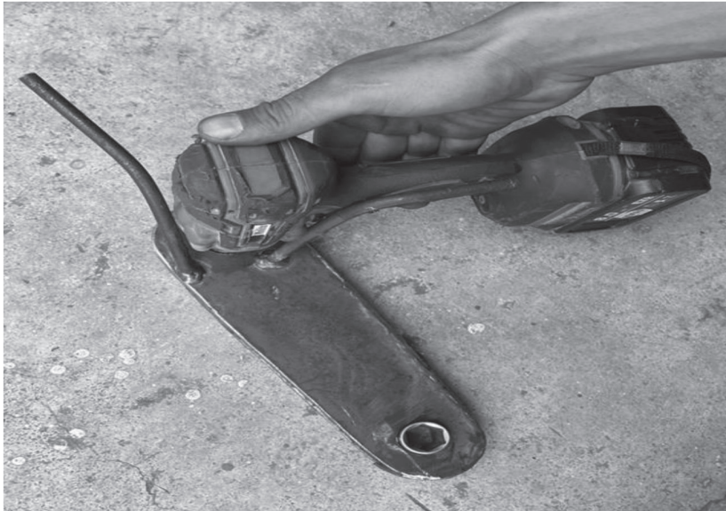
ภาพที่ 6 การหาตำแหน่งมือจับชุดสว่านขันน็อตหม้อแปลง
