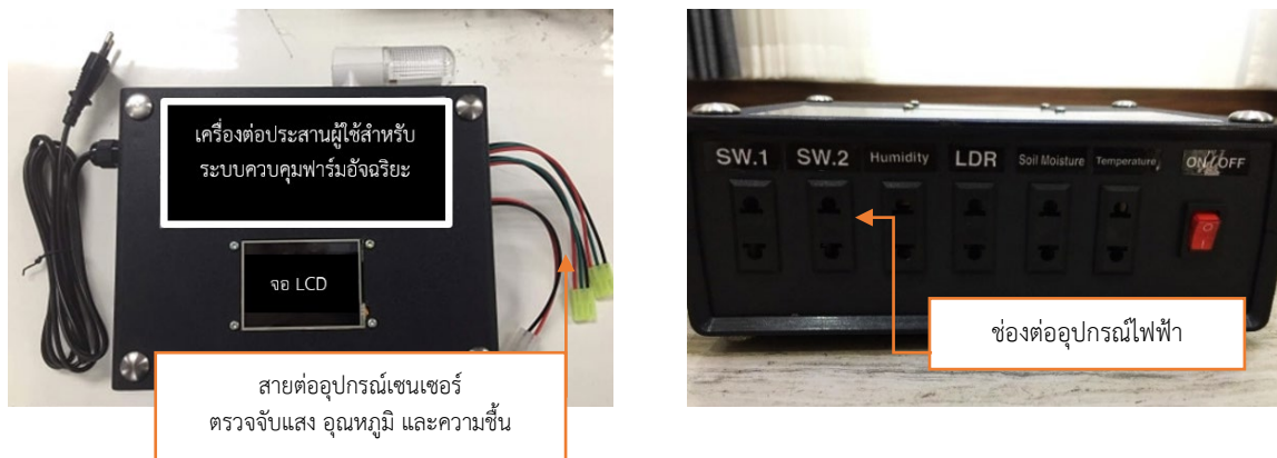
รูปที่ 4 เครื่องต่อประสานผู้ใช้สำหรับระบบควบคุมฟาร์มอัจฉริยะที่พัฒนาขึ้น
