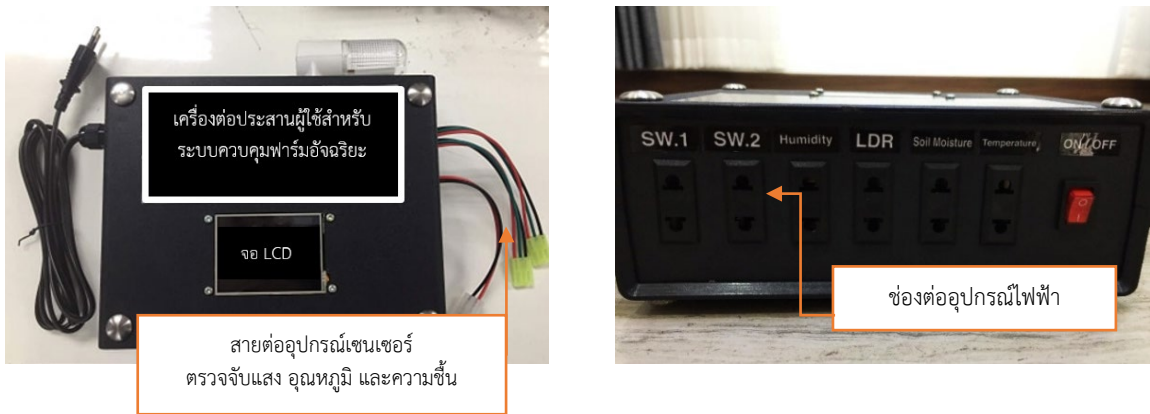
รูปที่ 4 เครื่องต่อประสานผู้ใช้สำหรับระบบควบคุมฟาร์มอัจฉริยะที่พัฒนาขึ้น
