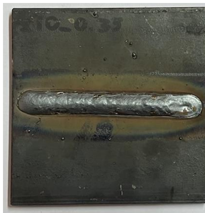
(ข) ชิ้นงานหลังเชื่อมเสร็จ
